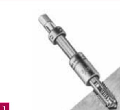
Asportare tutti i frammenti del maschio rotto, eventualmente anche con l'aiuto di aria compressa, fino a che tutte le scanalature risultino completamente libere. Lubrificare leggermente. Inserire quindi le aste dell'estrattore nelle scanalature del maschio, in modo lento ma deciso.
