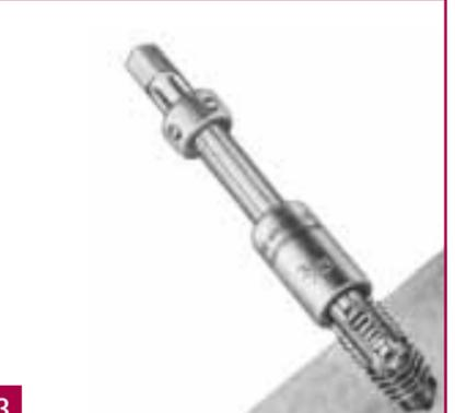
Applicare il giramaschi all'estrattore e ruotare alternativamente nei due sensi fino ad ottenere l'allentamento e quindi l'estrazione del maschio rotto.
